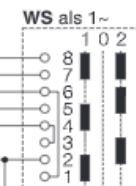
MWS 1,5 - 5 mit Wendeschalter WS und 1~ Ventilator mit Thermokontakt.
